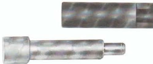
200751 Punzone per piantaggio sede 4 A 1
